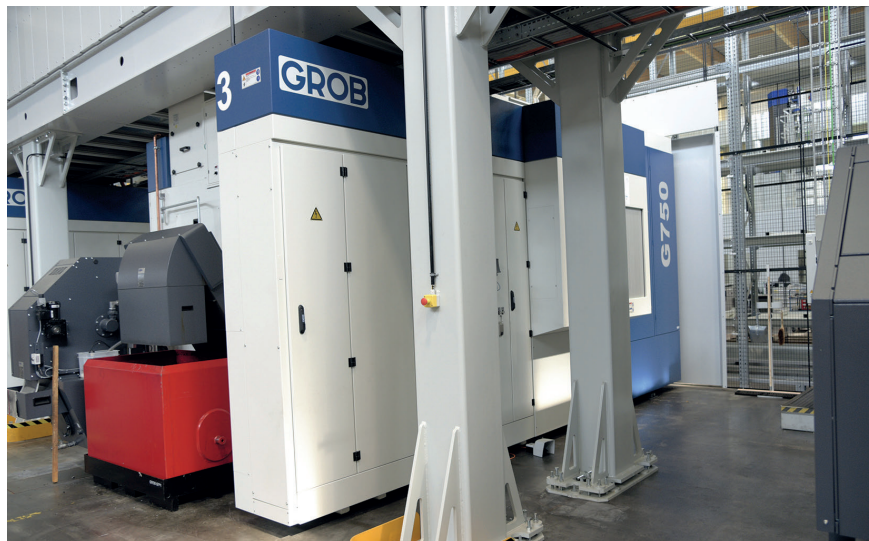
3 Die Grob G750 ist extrem kompakt: Späneförderer und Kühlmittel tank sind direkt in der Maschine integriert und belegen keine zusätzlichen Stellflächen © Grob-Werke
