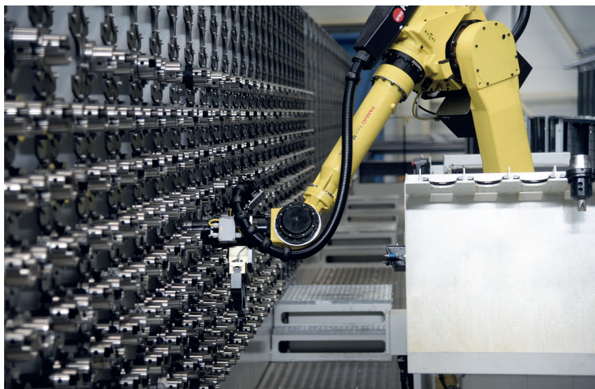
4 Das zentrale Werkzeugmagazin mit 870 Werkzeugen der Größe HSK-A100 ermöglicht eine hohe Flexibilität der Gesamtanlage, weil jedes Bauteil in jeder Maschine bearbeitet werden kann. Der Roboter hat zusätzlich einen Rucksack für noch schnelleres Be- und Entladen der Werkzeuge © Grob-Werke
