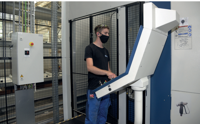
5 Einfahren von Bauteilen – Dominik Sohler, Anwendungstechniker Doppelmayr, hat uneingeschränkte Einsicht und Zugänglichkeit zum Arbeitsraum © Grob-Werke
